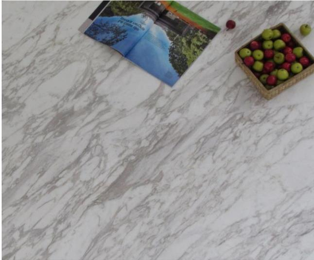
Geológicamente, el mármol es una roca metamórfica resultante de la recristalización de la piedra caliza. Dentro de esta definición geológica, el mármol término sólo se aplica correctamente a las rocas que contienen granos cristalizados de **calcita** (carbonato de calcio) o **dolomita** (carbonato de calcio y magnesio), o ambos.
