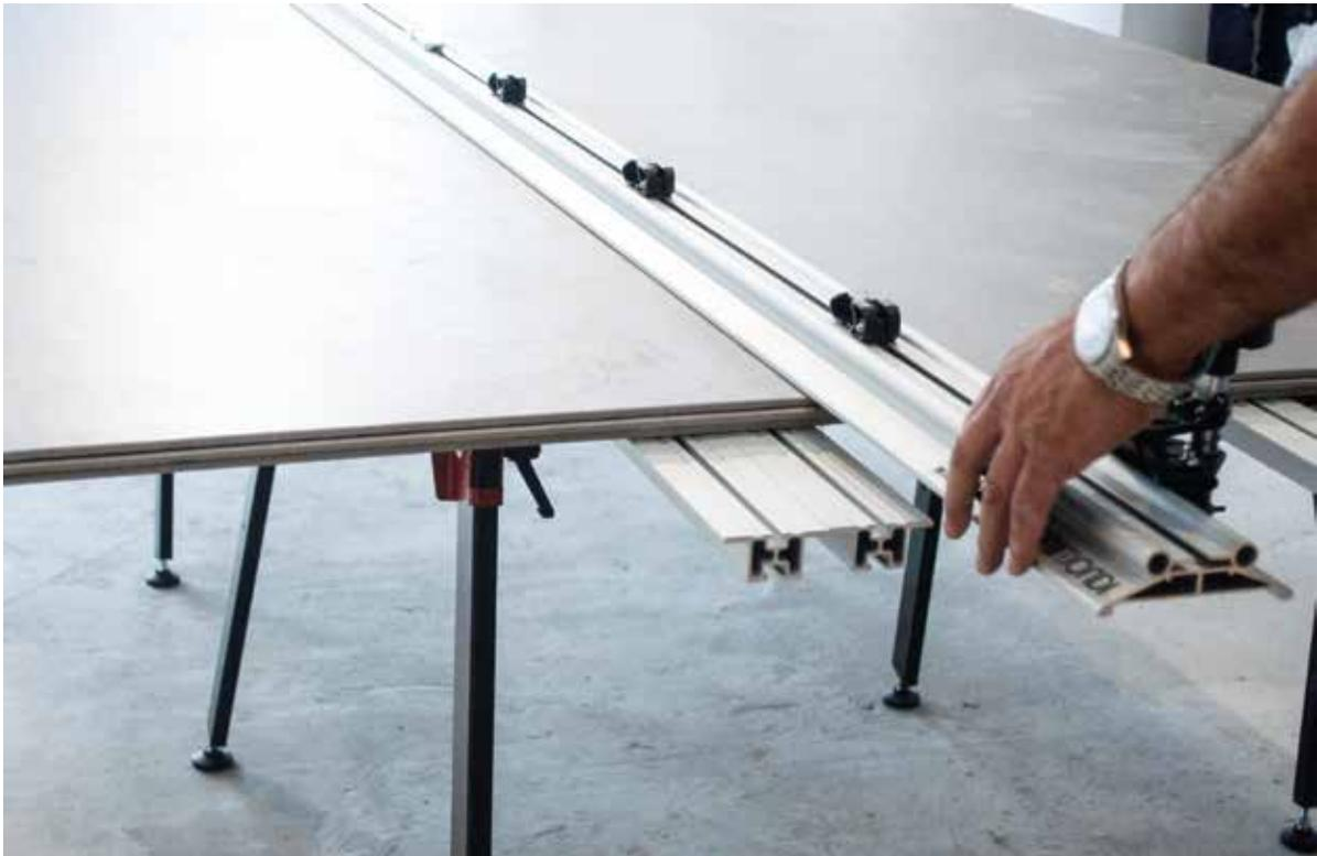
Una de las ventajas de piedra sinterizada es su facilidad y variedad de técnicas de corte. Una de las más comunes para corte de Grammarston es con guías de corte provistas de rodillos parecida a los cortadores tradicionales de cerámica. Esta técnica produce un corte o fractura perfecta y lineal en materiales de 6 y 12 mm.
