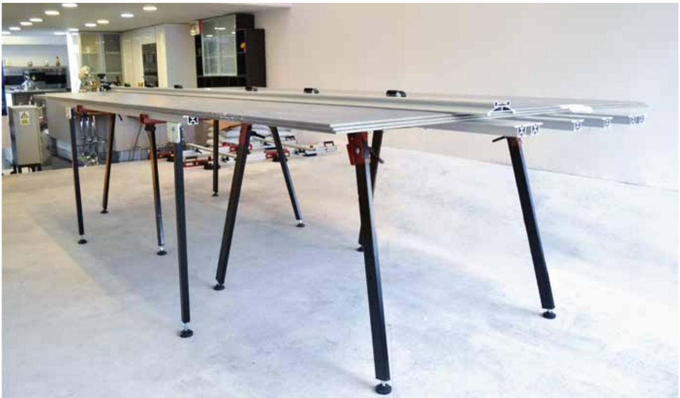
Para un buen resultado del corte, se debe posicionar la placa sobre una superficie estable, plana y que no se deforme. Se aconseja usar un banco con perfiles de aluminio como muestra la imagen.
