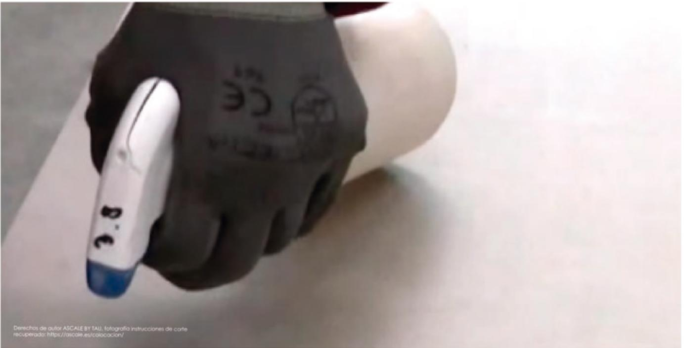
Las perforaciones circulares tienen que realizarse en húmedo con brocas diamantadas especializadas para piedra sinterizada ( Ver imagen)
