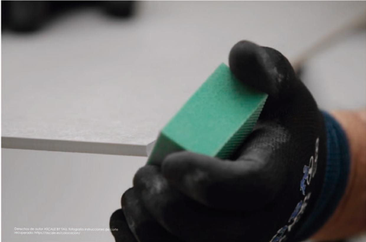
Siempre después de terminar cualquier corte lineal, realice un pulido de los bordes con una esponja diamantada. (Ver imagen)
