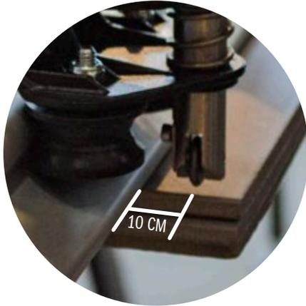
Primero ubique la guía de corte encima de la placa en correspondencia con el corte que se vaya a efectuar, fije la herramienta usando las ventosas que tiene el dispositivo. Tenga en cuenta para ubicar la línea de corte la distancia entre la regla y la rulina de corte.
