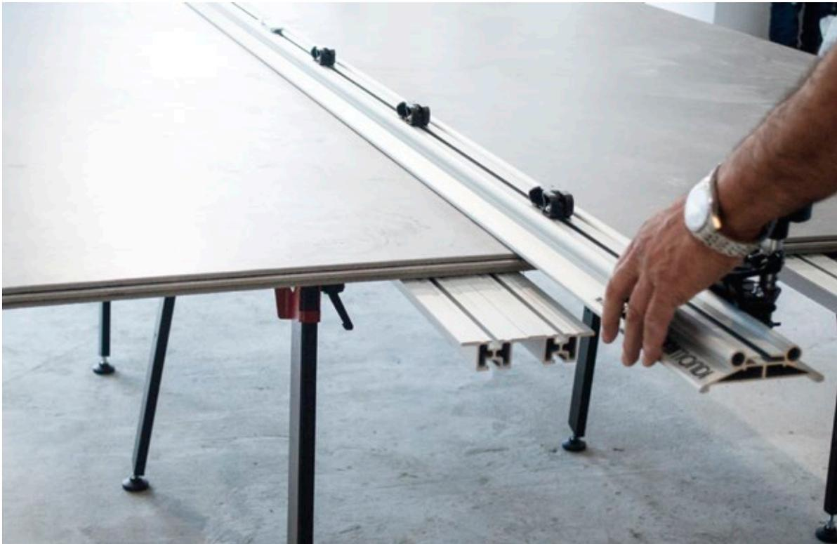
Una de las ventajas de piedra sinterizada es su facilidad y variedad de técnicas de corte. Una de las más comunes para corte de Gramarston® es con guías de corte provistas de rolina parecida a los cortadores tradicionales de cerámica. Esta técnica produce un corte o fractura perfecta y lineal en materiales de 6 y 12 mm.
