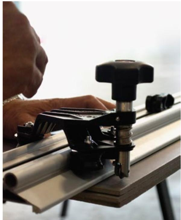
Talle 5 - 10 cm un extremo de la baldosa luego completar el corte de un borde al otro teniendo cuidado en mantener la misma presión mientras que se avanza.
